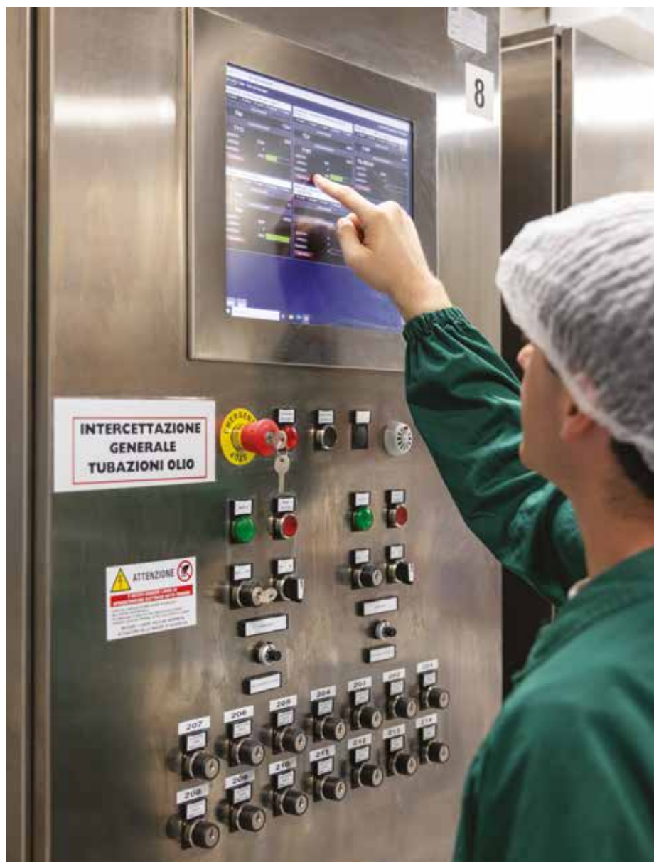
Sistema integrato di gestione e controllo dello scarico, dello stoccaggio e della movimentazione dell'olio sfuso
